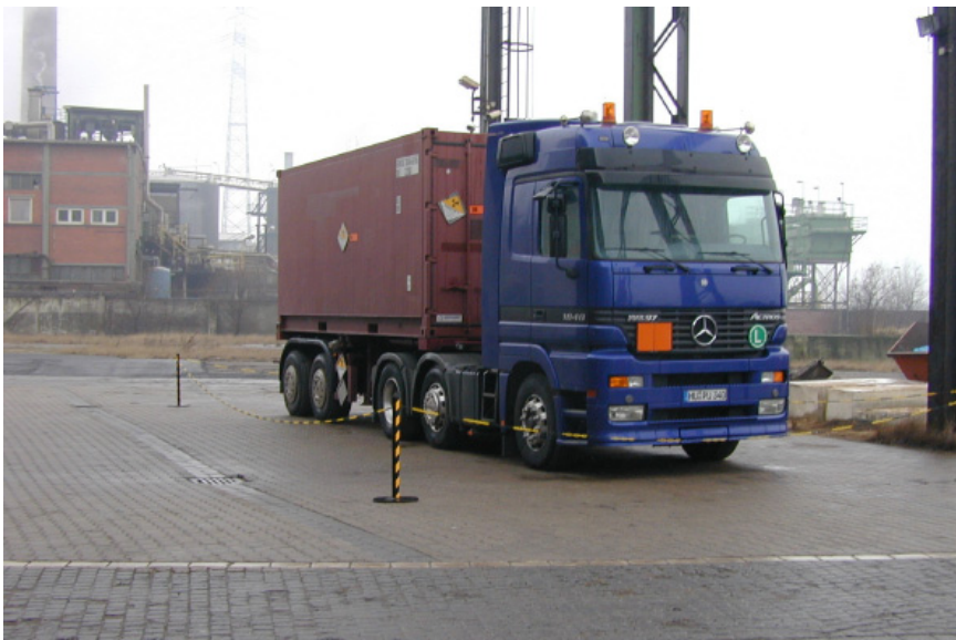
Abb. 6.8 Straßentransportfahrzeug für radioaktive Abfälle (Quelle: GNS)
