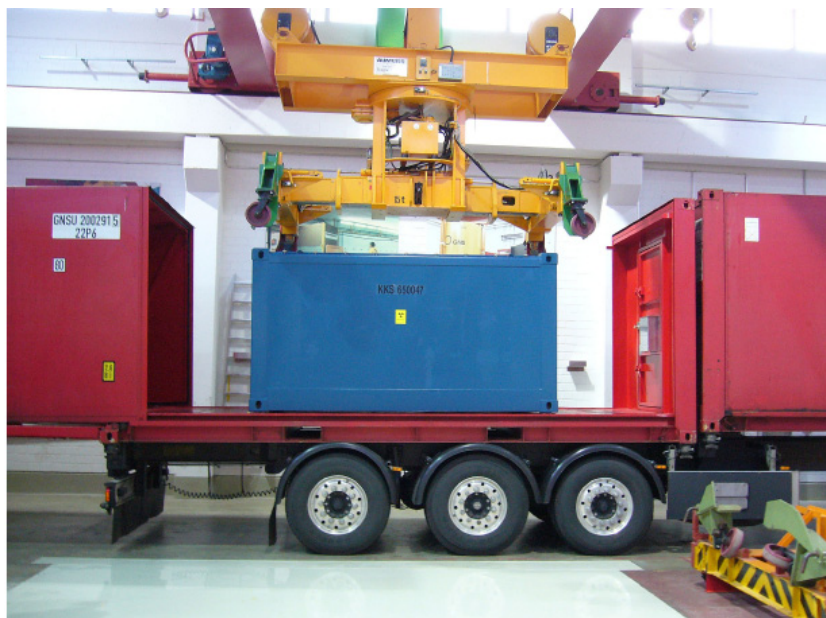
Abb. 6.4 Beispiel für den Umschlag eines quaderförmigen Abfallbehälters, hier mit Topspreadertechnik (Quelle: GNS)
