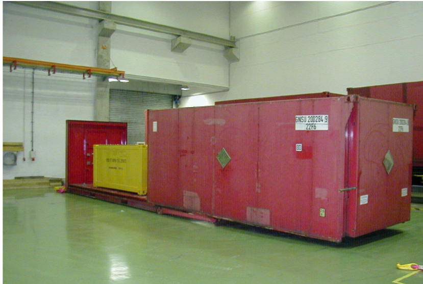
Abb. 6.5 Für Spreadertechnik geeigneter Abfalltransportcontainer (Typ IP-2) – 20'-Open-all-Container (Quelle: GNS)
